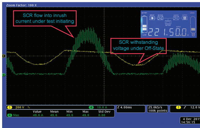
10KVA单相UPS启动瞬间，AC/DC整流电路中晶闸管BT155W-1200T可承受住高的瞬态侵入电流
